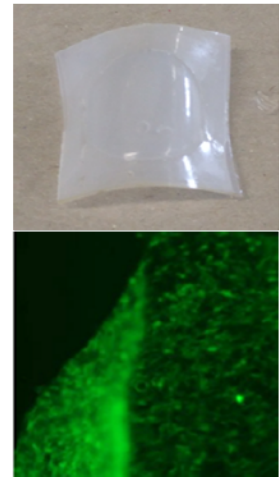
Arriba: Nylon recubierto de hidrogel termosensible. Abajo: monocapa celular despegándose por descenso de temperatura
