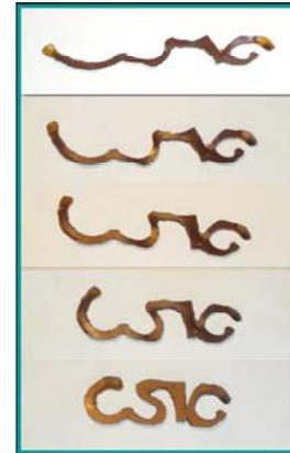
Recuperación de la forma original del caucho Acrilonitrilo-butadieno carboxilado (XNBR) después de ser deformado hasta su forma transitoria tras el incremento de la temperatura por encima de la temperatura de transición iónica.
